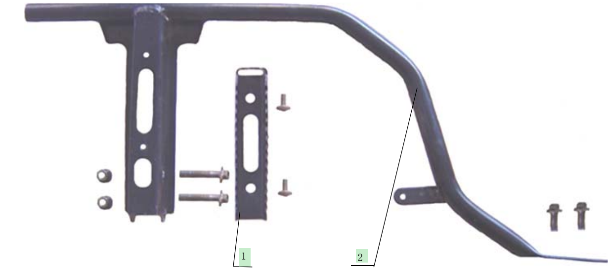
6、踏脚板支撑总成
