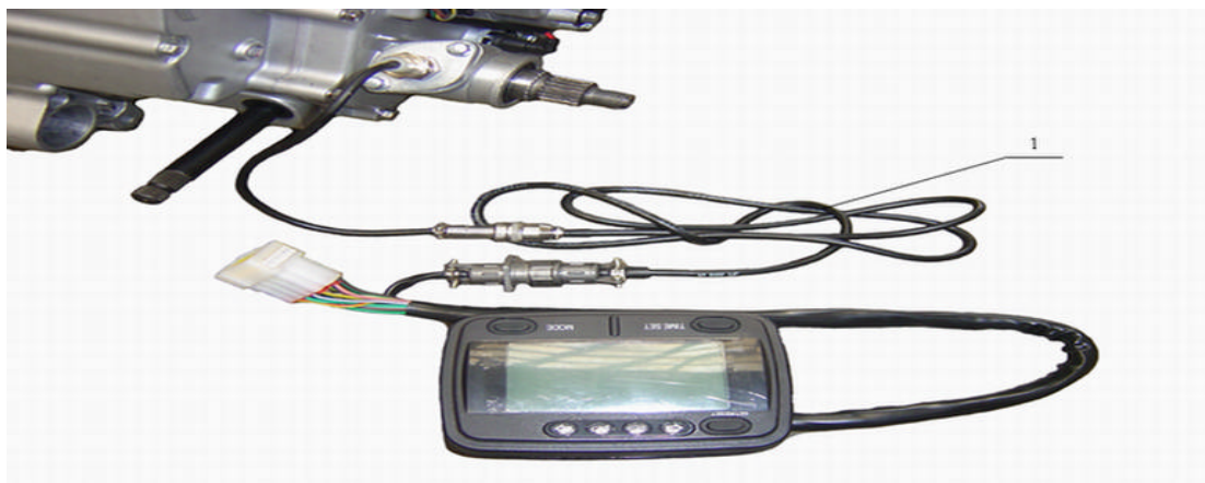
E23? ? ? ? ? ? Speed meter system
